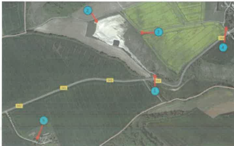
Figure 50 : Points de mesure des niveaux sonores (Prévention Normandie)
